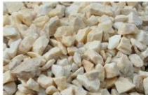
Granulat concassé Jaune Sienne sur les espaces de circulation
